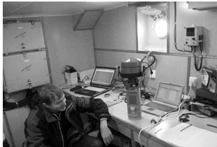
Установка режима работы доплеровского профилографа течений RDCP600 перед измерениями. Снс кфмн Будников А.А. в судовой лаборатории
